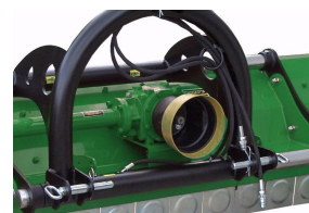
Hydr. lateral displacement (on demand) Déport latéral hydr. (sur demande) Spost.amento lat. idr. (a richiesta)
