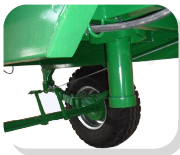
Dettaglio balestra e martinetto ribaltamento Leafspring and tipping cylinder Détail ressort à lames et vérin de basculement
