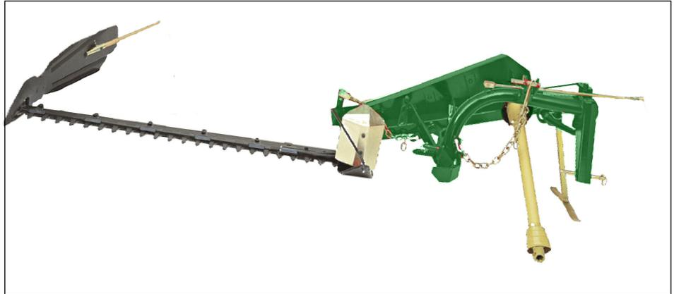
**Studiata per una rapida applicazione su qualsiasi trattore da 20 a 80 HP con attacco a tre punti. Il telaio a struttura tubolare, leggero e resistente di linea moderna, è fornito di sgancio rapido per evitare, in caso di urti, pericoli e danni alla barra. Le ampie inclinazioni di lavoro permettono il taglio di siepi, la pulizia di fossi o canali ecc. Taglia tutto senza ingolfarsi mai**
