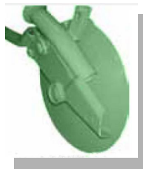
Assolcatore a disco semplice / Simple disc coupler / Butoir à disque simple
